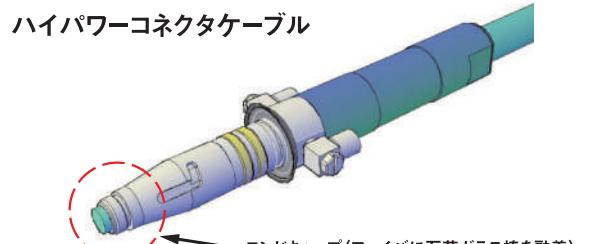
ハイパワーコネクタケーブル:異径融着技術、ガラス溶着技術、クラッドモードストリップ技術を用い、先端接着剤レスでKw級に対応したハイパワーコネクタケーブルを実現。
