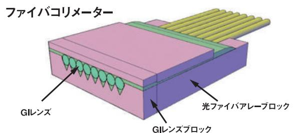
ファイバコリメーター:光ファイバから出たレーザ光を一斉に平行光に変換出来、通信機器メーカ大手に納品している。
